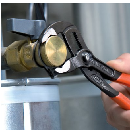
Zuby přesazené proti směru otáčení způsobují samosvorný efekt a zabraňují sklouznutí po obrobnku.
